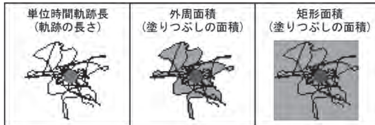
図2 バランス変数のイメージ図(中心の円:測定開始時のCOPの位置)
